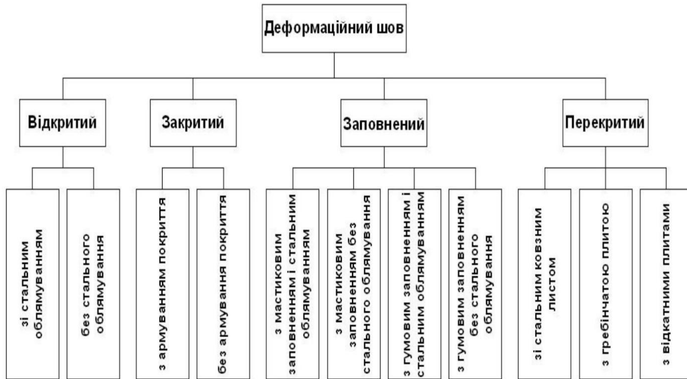
Рисунок 1. Класифікація конструкцій деформаційних швів
