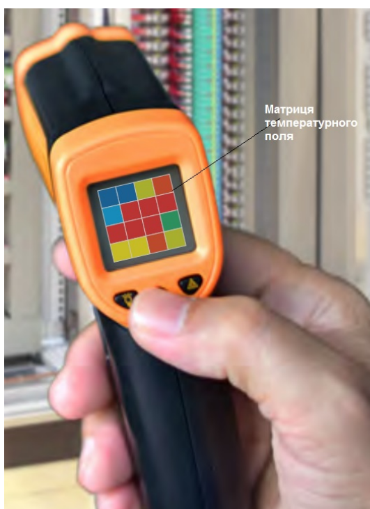
Рисунок 3.7 – Матричний ІЧ пірометр D6T-32L (OMRON)
