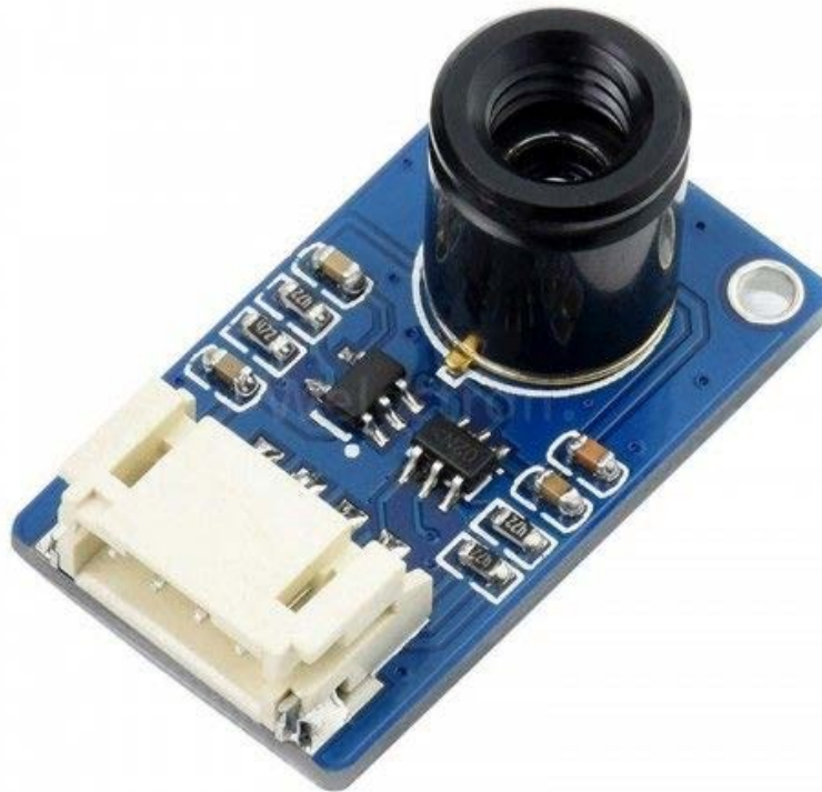
Рисунок 3.8 – Матричний ІЧ датчик температури MLX90640-D55
