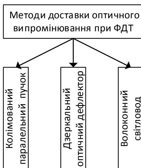
Рисунок 2.4 – Методи доставки світла до БТ при ФДТ
