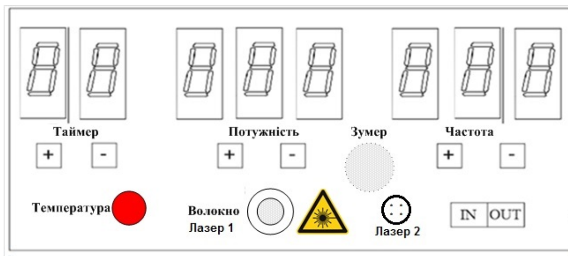
Рисунок 3.2 – Загальний вигляд передньої панелі цифрового пристрою для лазерної фототерапії пухлин
