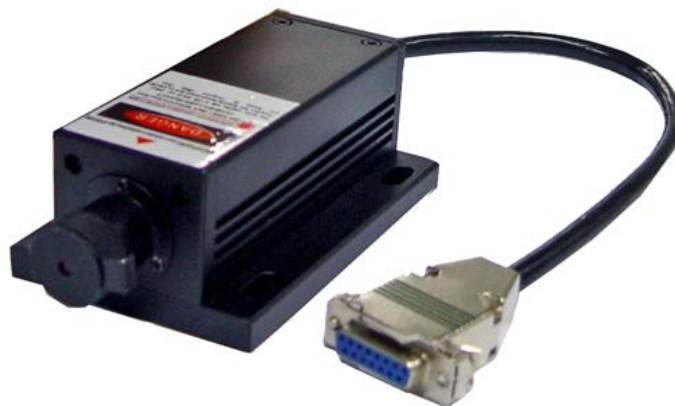
Рисунок 3.2 – Лазерний модуль для розробленої установки
