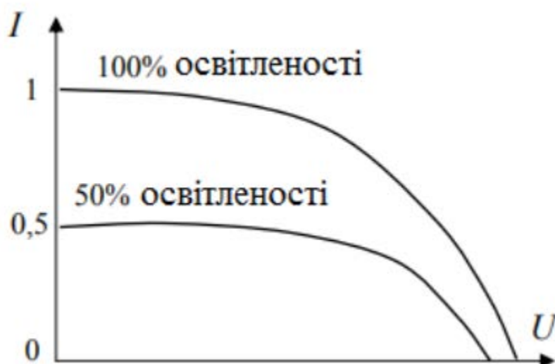
Рисунок 1.7 — Характеристики СП в залежності інтенсивності сонячного випромінювання
