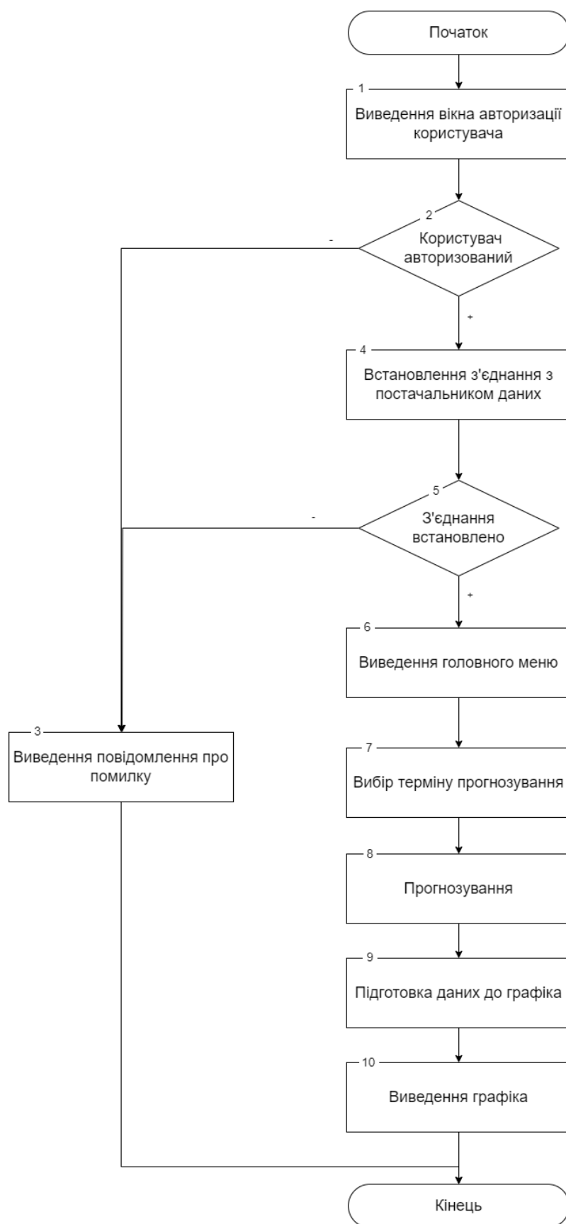
Рисунок В.4 – Схема загального алгоритму функціонування програмного модуля прогнозування курсу «Біткоїн»
