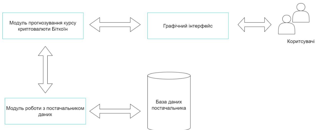
Рисунок 3.2 – Загальна структурна модель програмного модуля
