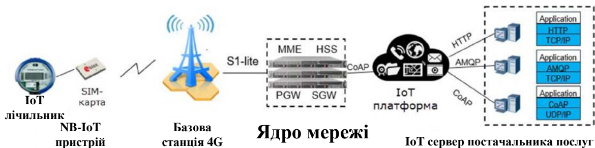
Рисунок 5 - Архітектура NB-IoT мережі для послуг ЖКГ
