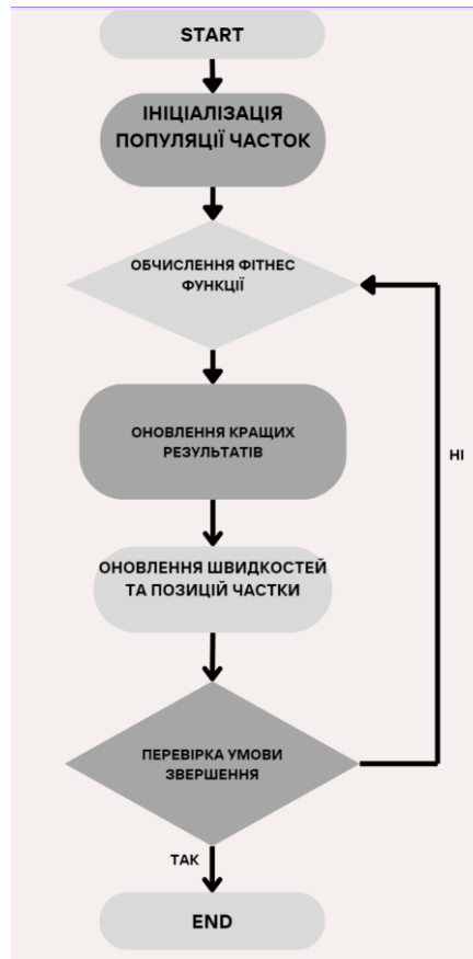
Рис 3.2 Схема роботи оптимізації параметрів системи виявлення атак у вдосконаленому алгоритмі рою часток
