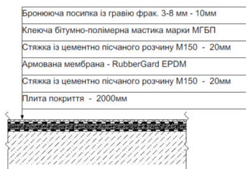
Рисунок 4.11 – Влаштування покрівлі
