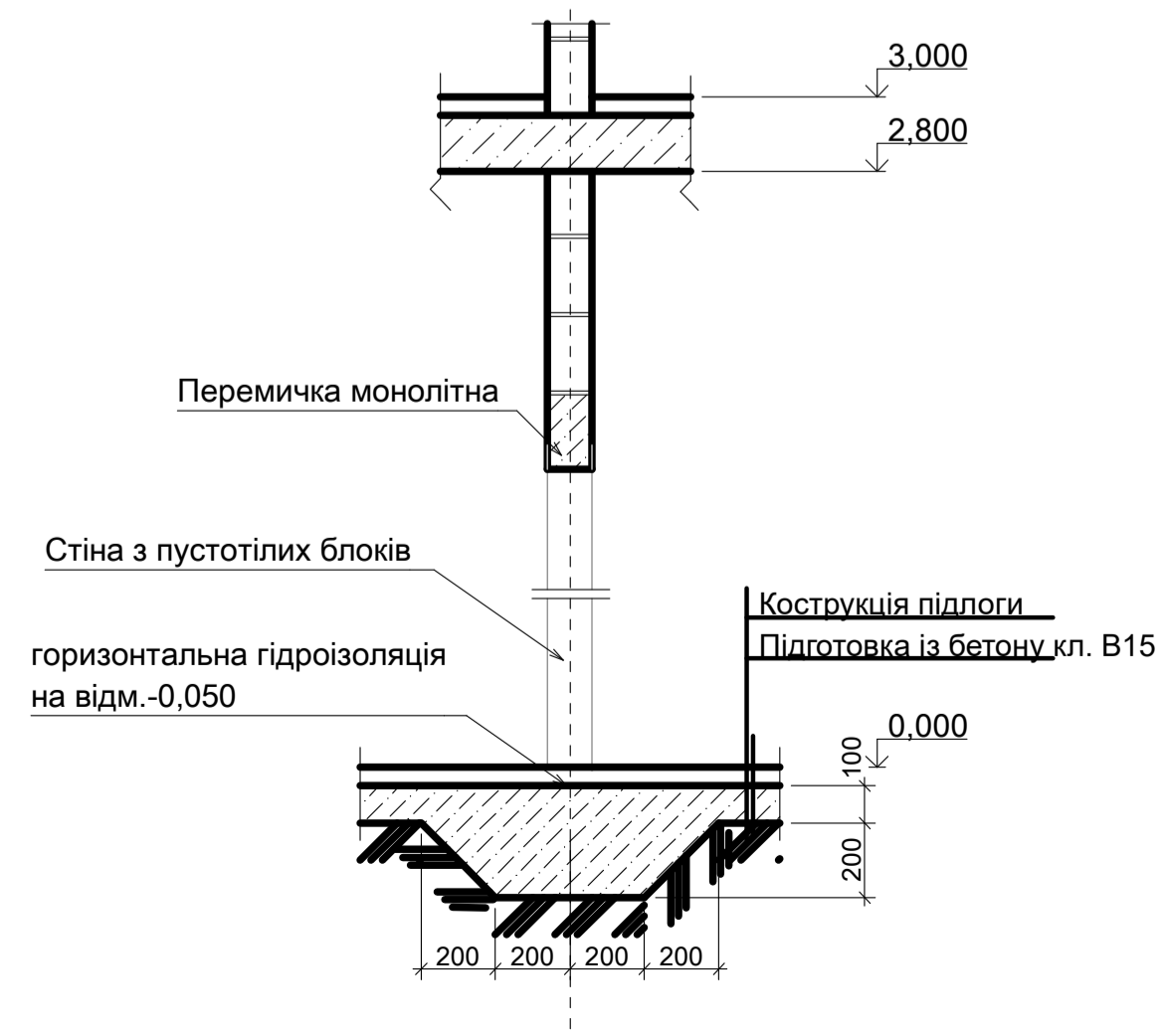
Вузол 4 М 1:20 Деталь утовщення бетонної підготовки (під цегляні перегородки товщ. 120 мм)
