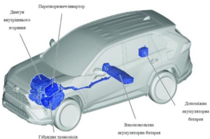
Рисунок 5.1 – Розміщення основних вузлів гібридного системи в Toyota RAV4 Hybrid
