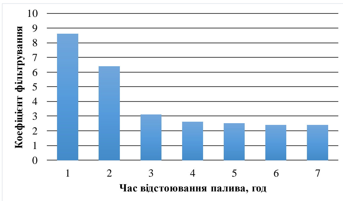
Рисунок 3.3 –Залежність коефіцієнту фільтрування від часу відстоювання суміші палив B25
