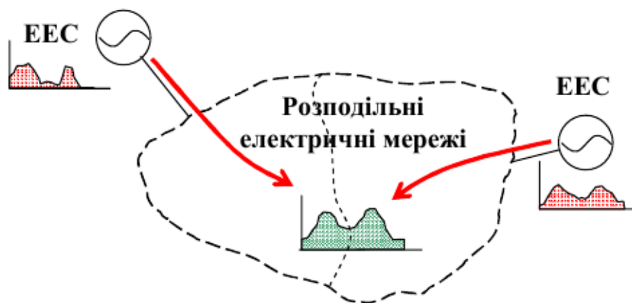
Рисунок 1.2 – Розподільні електричні мережі з централізованим живленням
