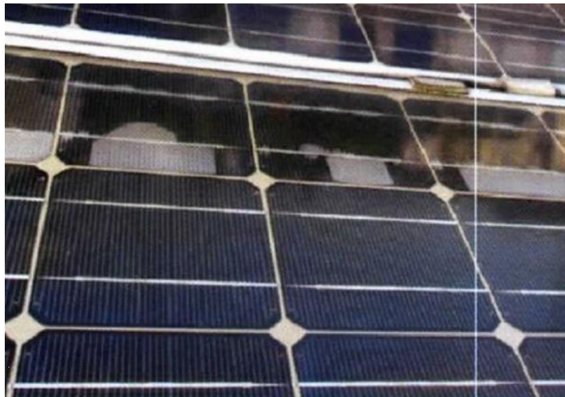
Рисунок В.1 - Розшарування та деградація cells ФЕМ
