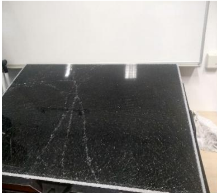
Рисунок В.8 – Тріщини на захисному склі ФЕМ
