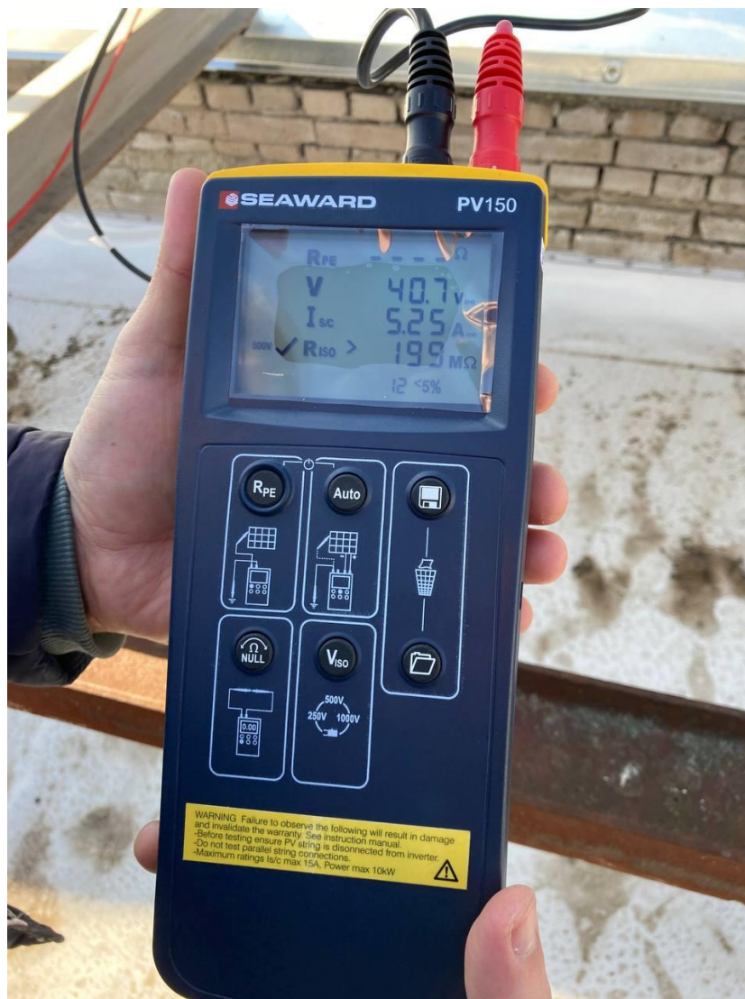
Рисунок 3.16 – Збір даних для оцінювання ефективності генерування електроенергії даховою ФЕС
