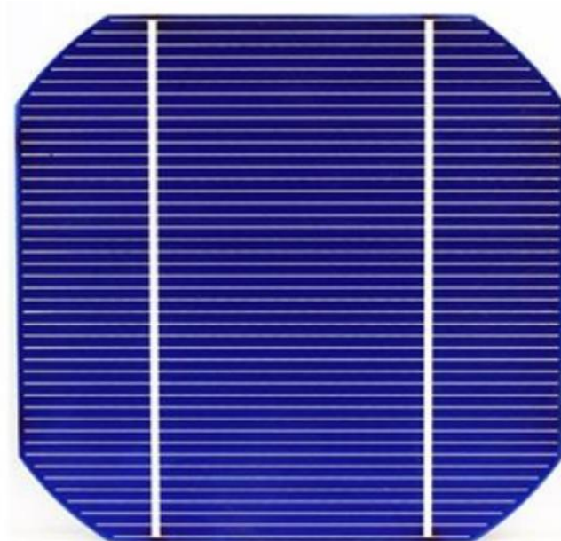
Рисунок 1.2 – Монокристалічний кремнієвий сонячний елемент
