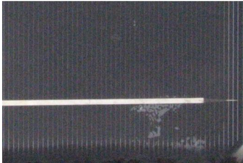
Рисунок В.6 – Дефект «слід равлика»
