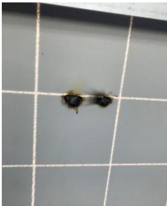
Рисунок В.14 – Пошкодження контактів в місці з'єднання cell з busbar
