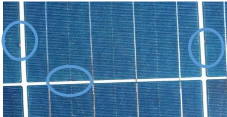
Рисунок В.19 – Потемніння, спричинені особливостями виробництва
