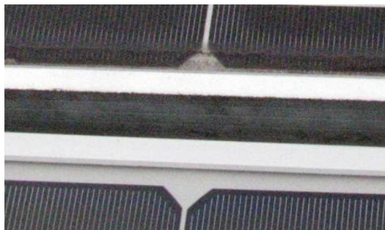
Рисунок В.7 – Вплив забруднення на фотоелектричну панель
