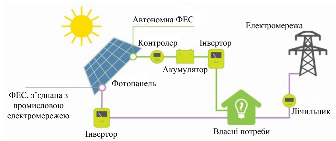
Рисунок 1.8 – Принцип роботи фотоелектричної станції
