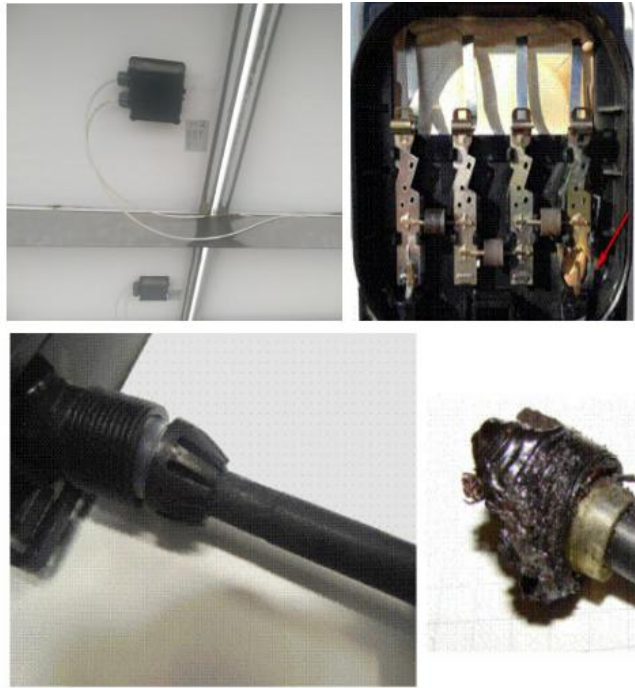
Рисунок Г.16 – Перегрів у клемному терміналі junctionbox
