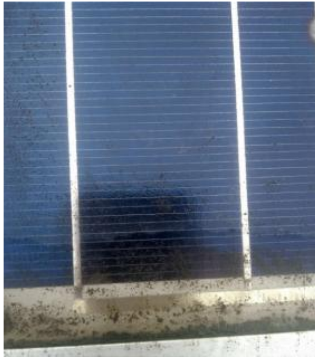
Рисунок В.12 – Пошкодження герметика ФЕМ
