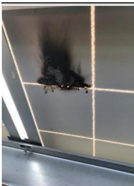
Рисунок В.15 – Пошкодження діоду Шоттки
