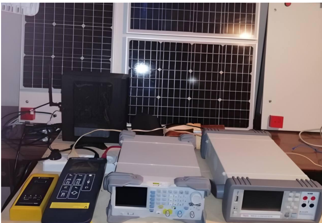
Рисунок 3.17 – Апаратна частина комплексу визначення технічного стану ФЕС
