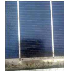
Пошкодження герметика ФЕМ
