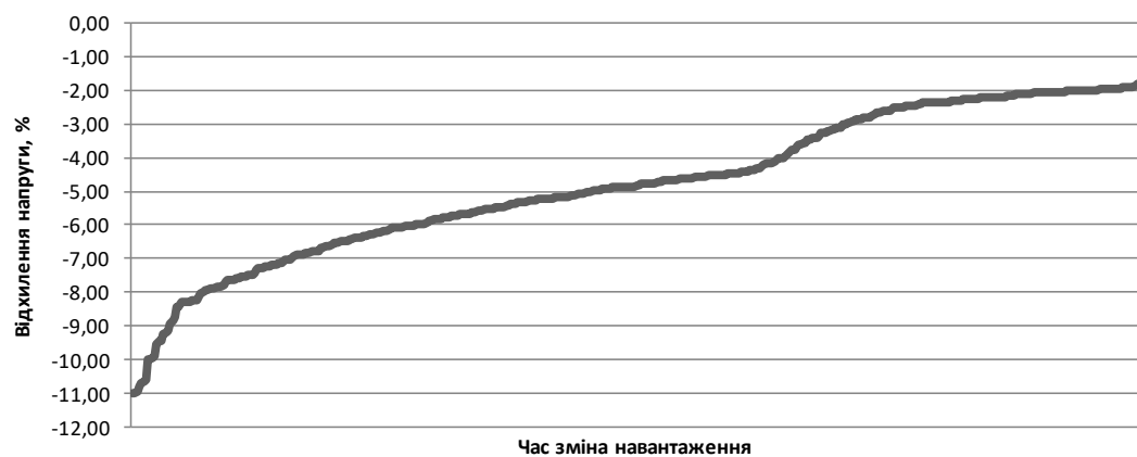
Рисунок 9.13 – Відхилення напруги на затискачах ТП-457 протягом року
