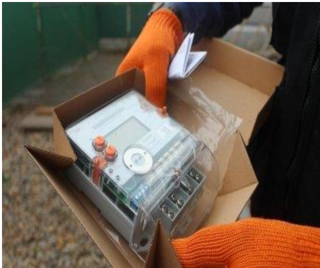
Рисунок 3.4 – Багатотарифні лічильники МТХ для обліку електричної енергії
