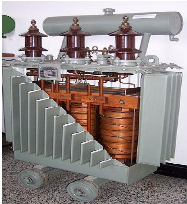
Рисунок 3.4 – Трифазний силовий масляний трансформатор з вирізом у баку для демонстрації конструкції
