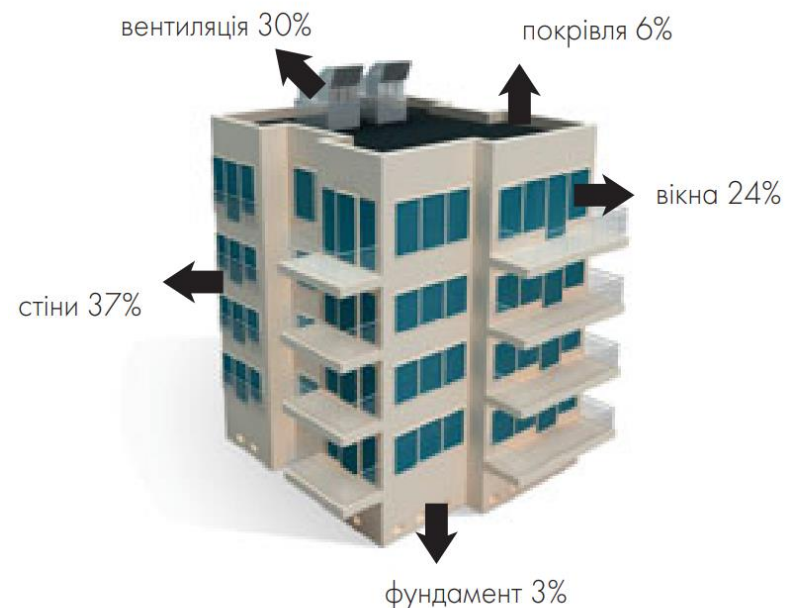
(10-поверховий будинок із залізобетонних конструкцій)
