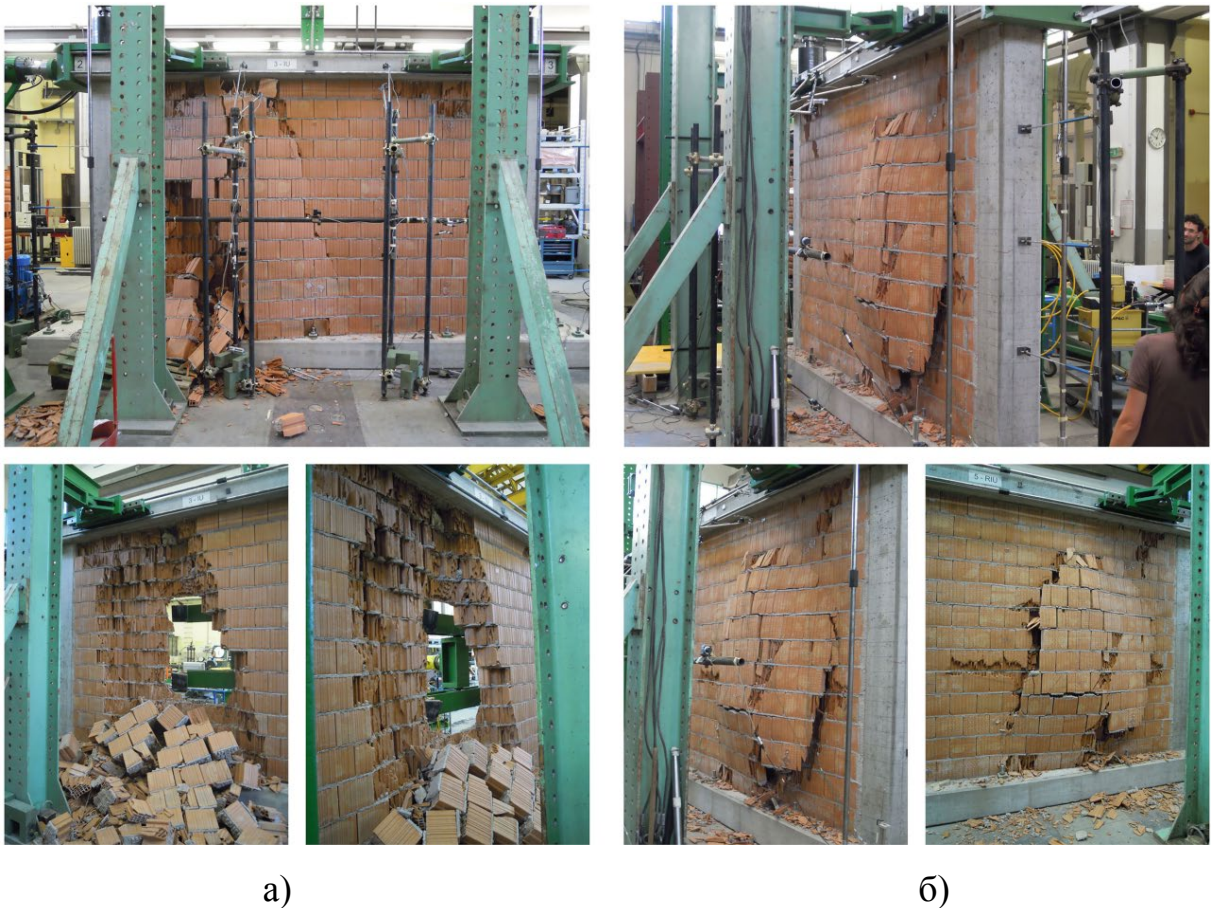
Рисунок 1.6 – результати випробувань неармованих (а) та армованих (б) стін заповнення одноповерхових залізобетонних рам [8]
