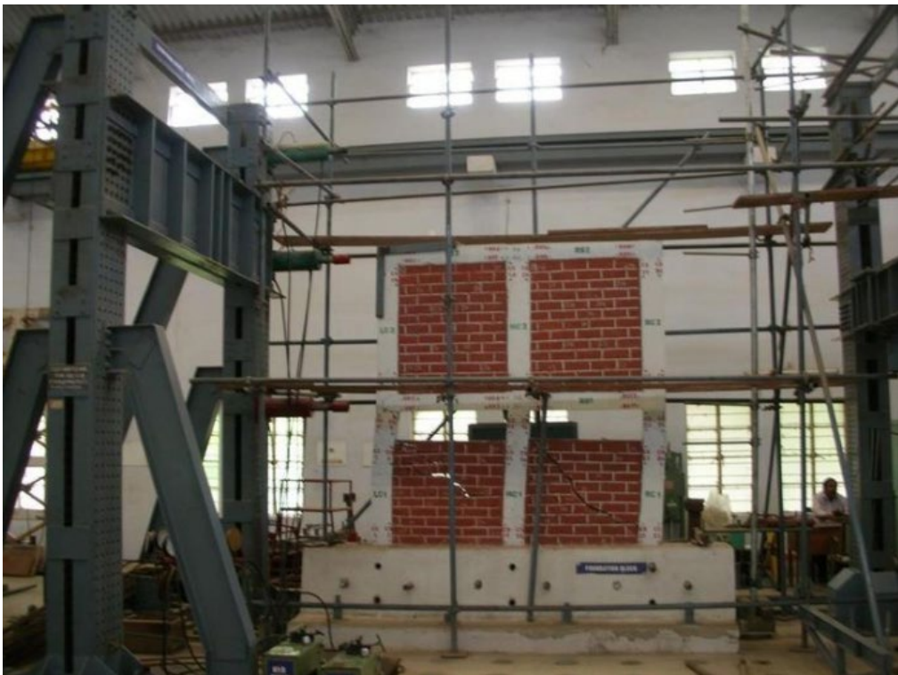
Рисунок 1.4 – Загальний вигляд випробувального зразка дворівневої залізобетонної рами із стіновим заповненням із глиняної цегли [5]
