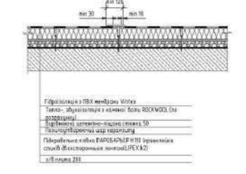
Вузол влаштування покриття М 1:20
