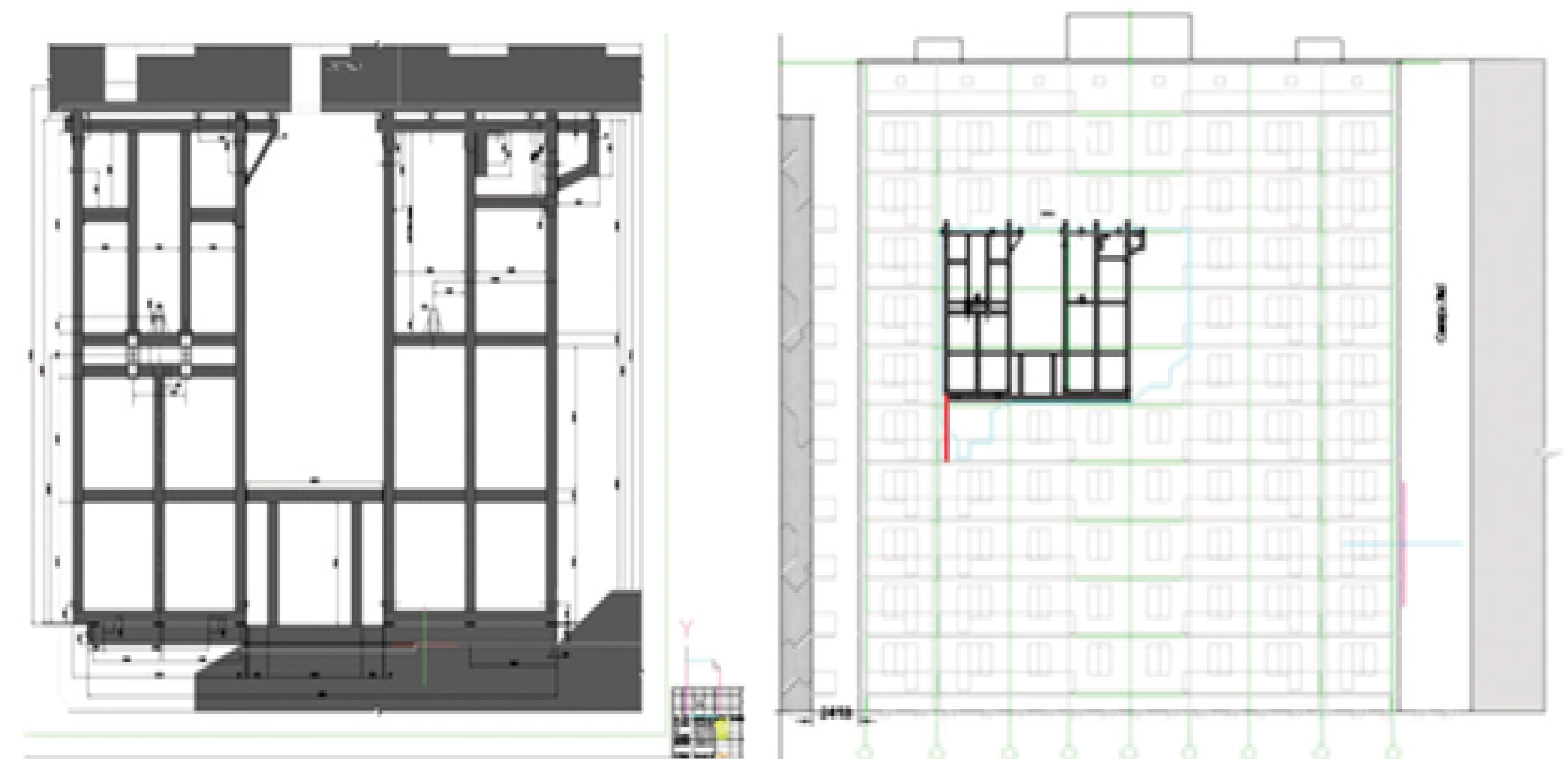
Рис. 2.6 – Схема підсилення будівлі: а – схема підсилюючої рами, б – схема установки підсилюючої рами
