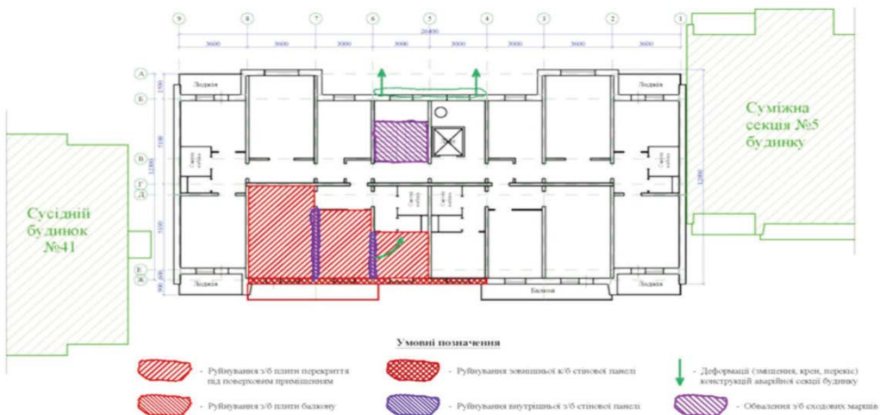
Рис. 2.1 – Аварійний будинок на вул. Соломії Крушельницької в м. Києві: а — руйнування головного фасаду; б — карта дефектів на плані типового поверху
