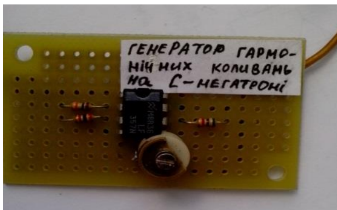
Рисунок 2.8 – Схема генератора гармонічних коливань на основі конвертора імпедансу
