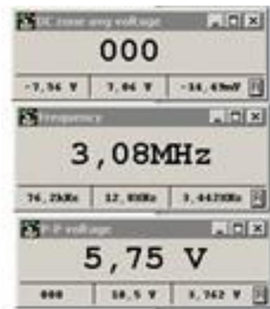
Рисунок 2.11 – Графік частоти синусоїди при значенні 3,08 МГц і розмахом 5,75 В
