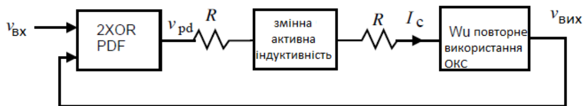
Рисунок 2.11 - Блок-схема активного індуктора ФАПЧ струмового режиму від ДіКлементе та Юаня [38].
