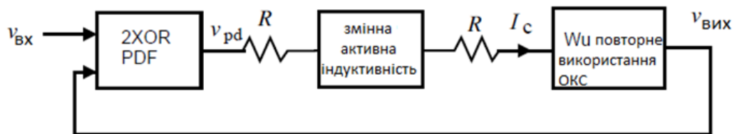
Рисунок 10 - Блок-схема активного індуктора ФАПЧ струмового режиму від
