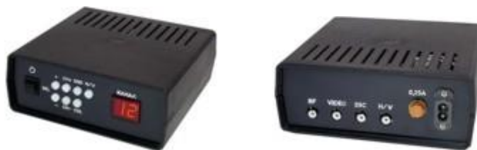
Рисунок 2 – Лицьова та задня панель генератора тестових телевізійних сигналів ГТТС-03
