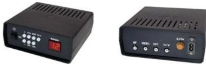
Рисунок 2.8 – Лицьова та задня панель генератора тестових телевізійних сигналів ГІТС-03
