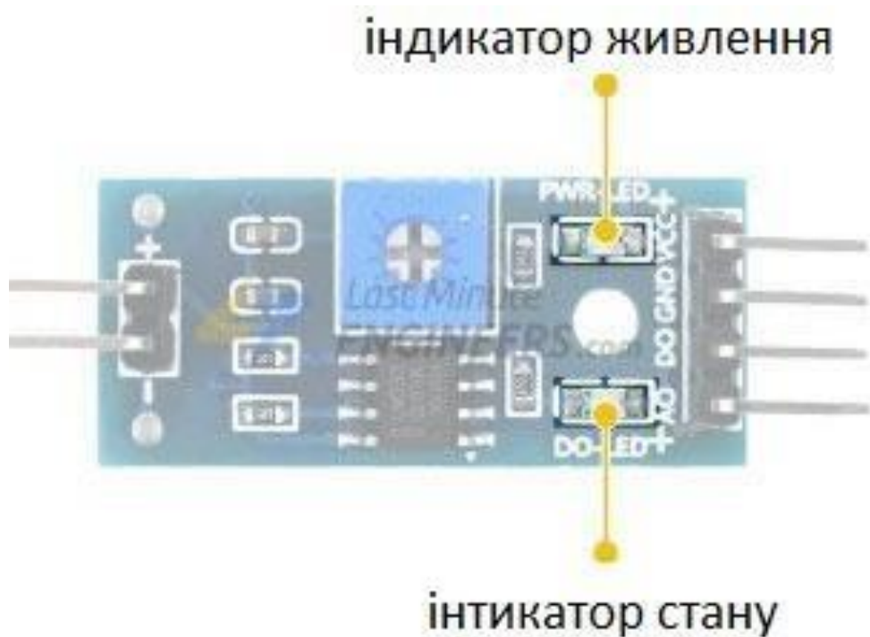
Рисунок 3.4 – Світлодіодні індикатори живлення і стану ґрунту
