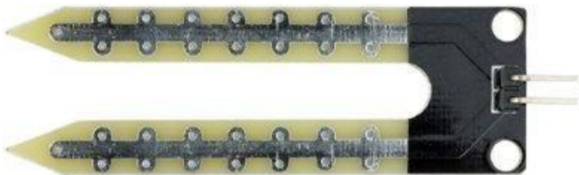
Рисунок 3.2 – Зонд датчика вологості ґрунту містить електронний модуль, який з'єднує датчик з Arduino
