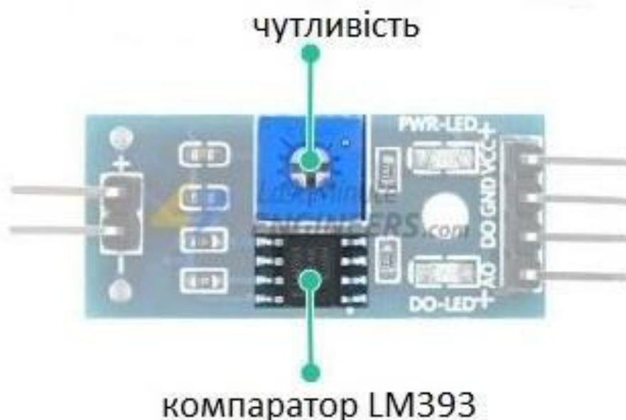
Рисунок 3.3 – Регулювання чутливості датчика вологості ґрунту
