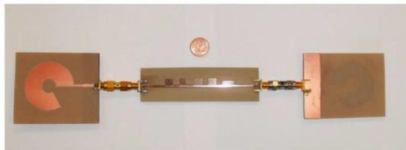
Рисунок 2.9 – Фотографія п'ятибітної мітки без мікросхем, оснащеної двома ширококутовими антенами з круговою поляризацією
