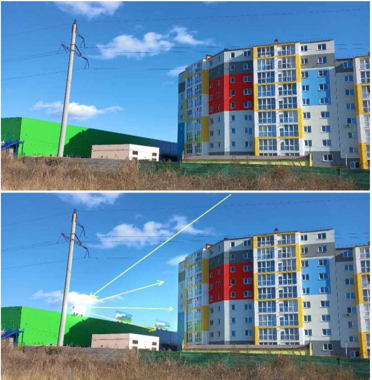
Рисунок 4.7 – Концепт дзеркал для збільшення інсоляції
