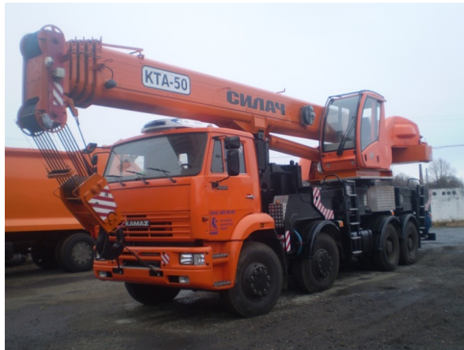
Рисунок 4.5 – Стріловий кран КАМАЗ КТА – 50
