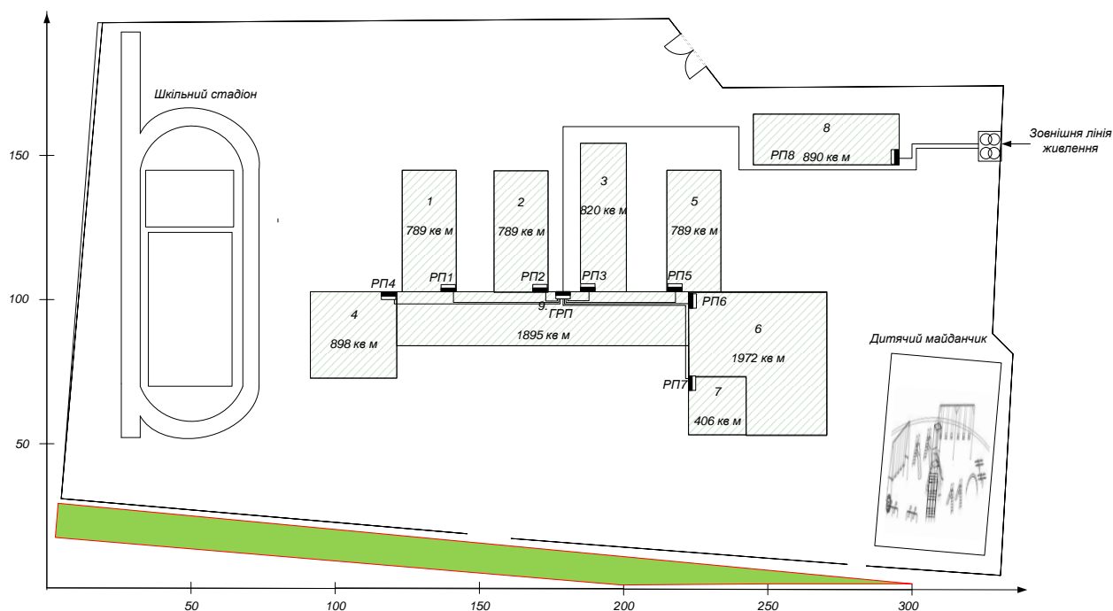
Рисунок 2.9 – Розміщення інженерних мереж на генеральному плані закладу
