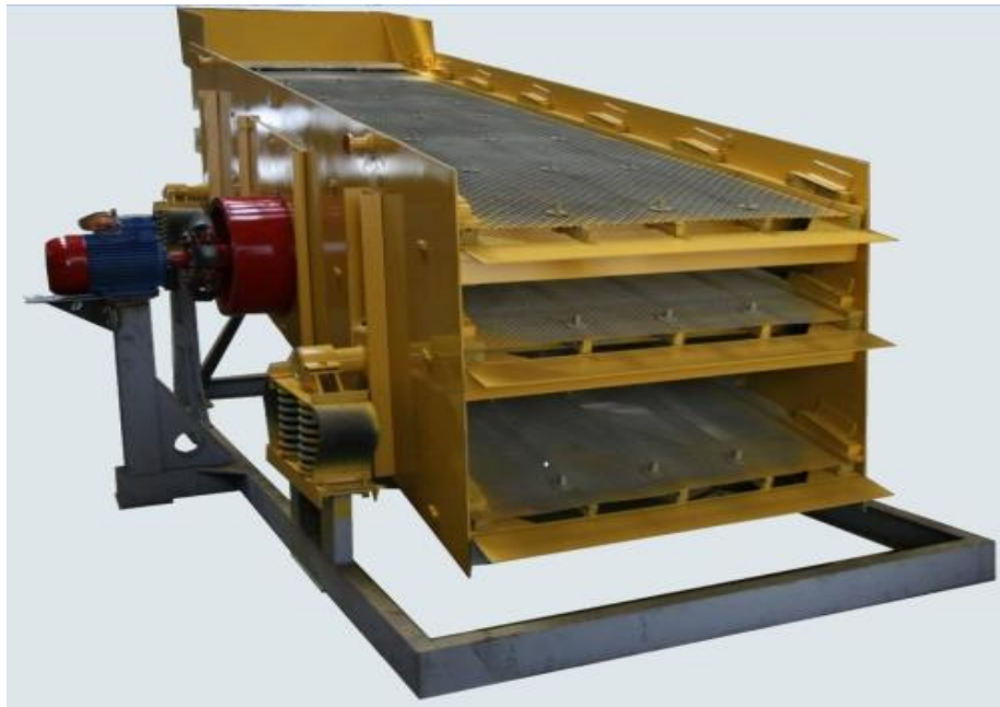
Рисунок 1.1 – Зовнішній вигляд грохоту ГІЛ 52А
