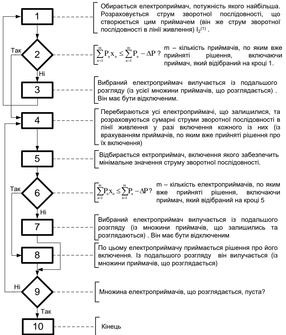
Рисунок 3.1 – Алгоритм розрахунку оптимального рішення щодо обмеження потужності групи електроприймачів несиметричного виконання
