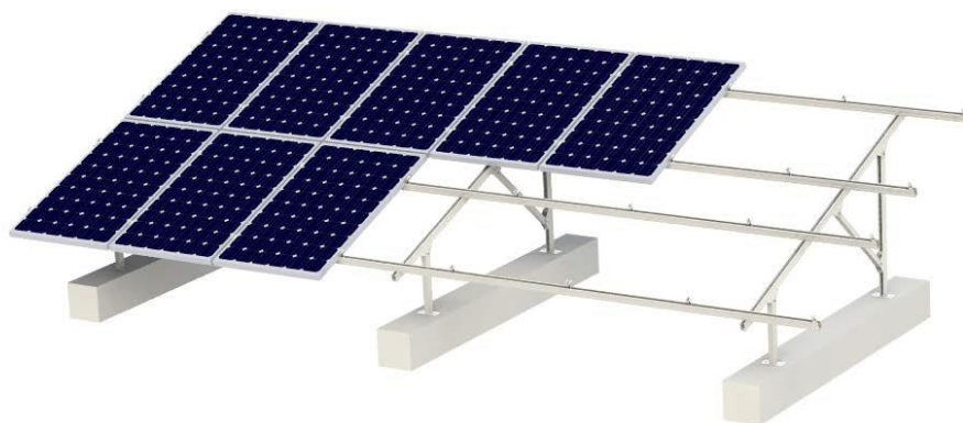
Рисунок 3.4 – Наземна система кріплення фотогальванічних модулів
