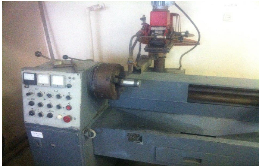
Рисунок 2.1 – Вал з нанесеною обмазкою на основі графіту (80 % дисперсного порошку графіту з нанопластинами графену + 20 % рідкого скла)
