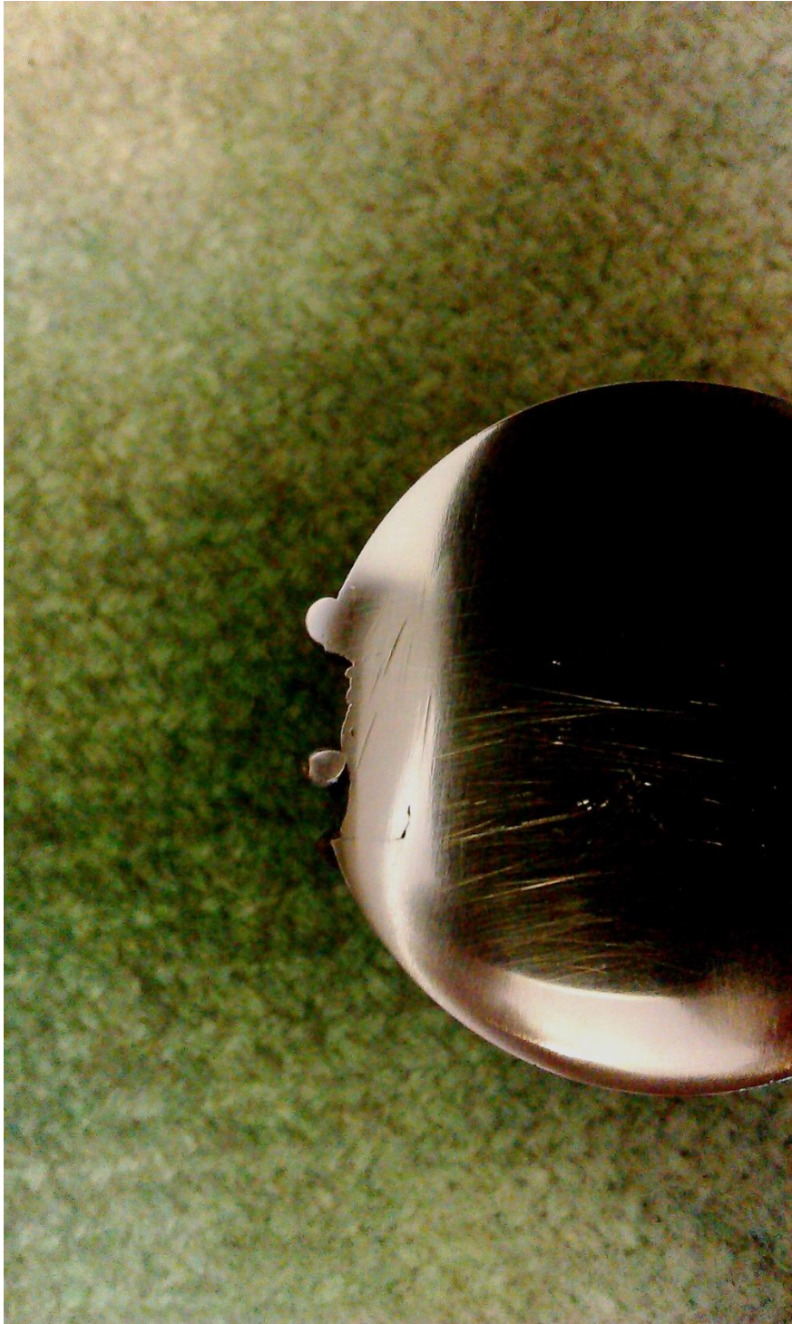
Рисунок 1.5 - Зразок №2, наплавлення на швидкості подачі дроту 10 мм/с
