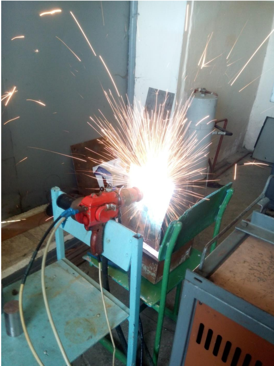
Рис 1.2 - Експериментальне напилення на деталь з використанням металізатора EM-14 M
