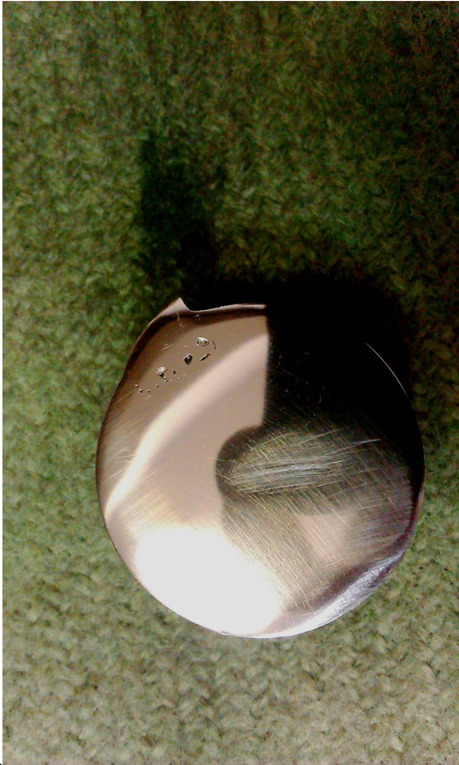
Рисунок 1.6 - Зразок №3, наплавлення на швидкості подачі дроту 15 мм/с
