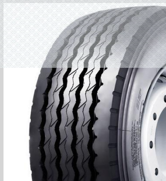
Рисунок 3.3 – Віддзеркалення рисунку протектора для причепів та напівпричепів
