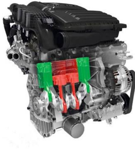
Рисунок 4.1 – Система відключення групи циліндрів
