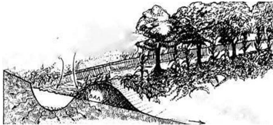
Рисунок 3.5 – Вали-канави влаштовані по горизонталях, служать не для транспортування, а для збору дощових вод, які потім повільно всмоктується в ґрунт. Вал зазвичай засаджується деревами та чагарниками
