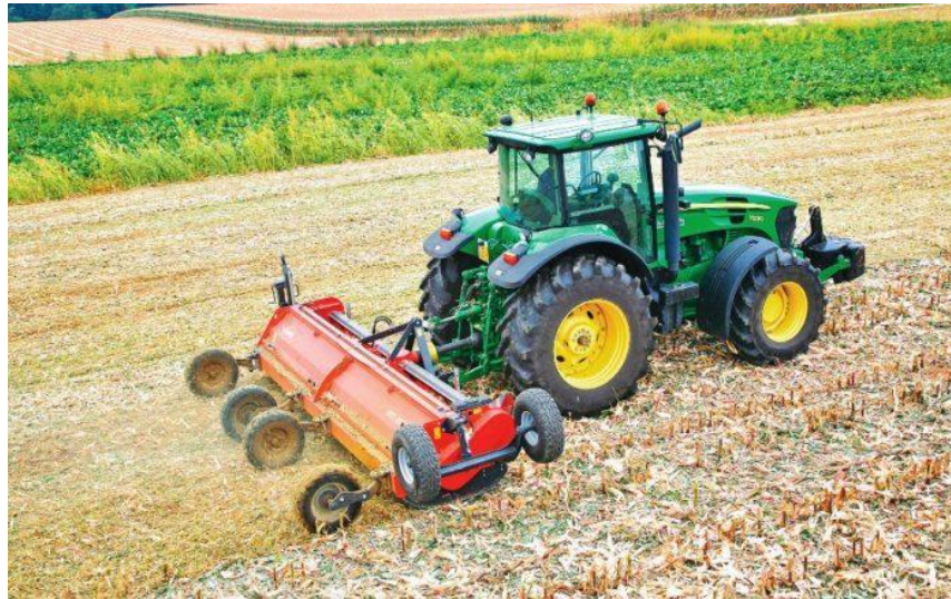
Рисунок 3.11– Мульчування ґрунтів від водної та вітрової ерозії
