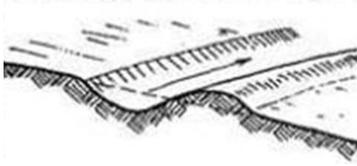
Рисунок 3.3 – Транспортування води з основних потоків в загати, а також збір дощової води відбувається за рахунок спеціальних каналів, які є одним з найважливіших компонентів подібних систем
