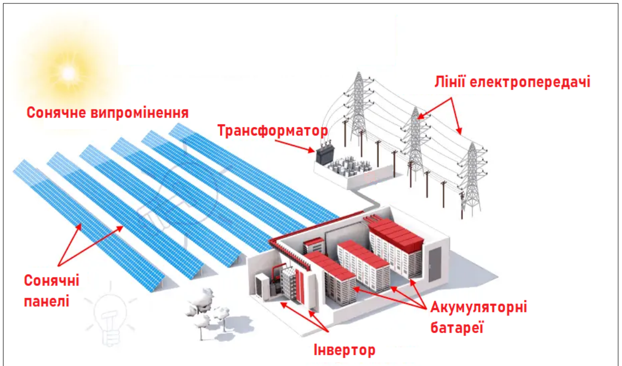
Рисунок 1.2 – Типова схема фотоелектричної станції
