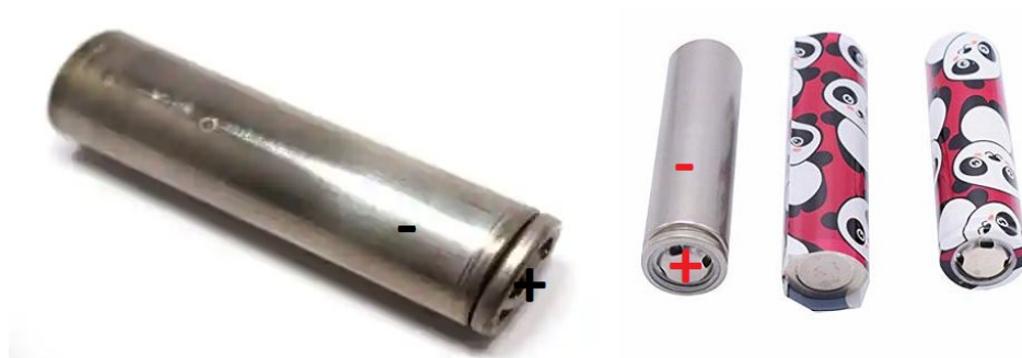
Рисунок 2.24 – Захисна плівка на акумуляторі 18650
