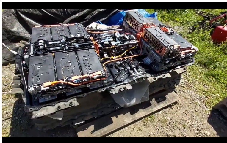
Рисунок 3.3 – Батарея Honda Clarity під час розбору
