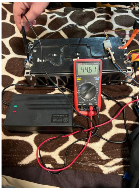
Рисунок 3.15 – Спрацювання реле при напрузі 44,61 В
