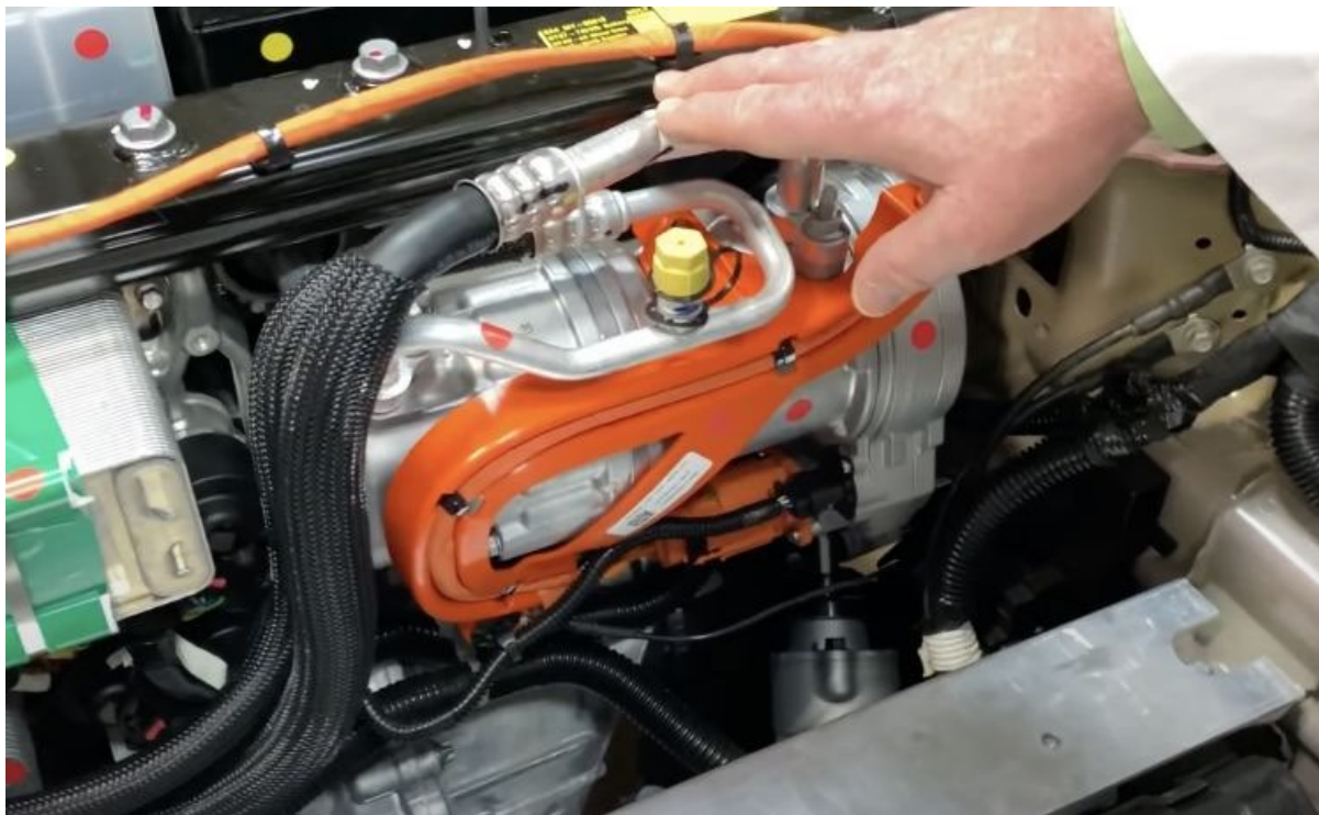
Рисунок 2.5 – Вигляд теплонасосу в електромобілі Tesla Model Y
