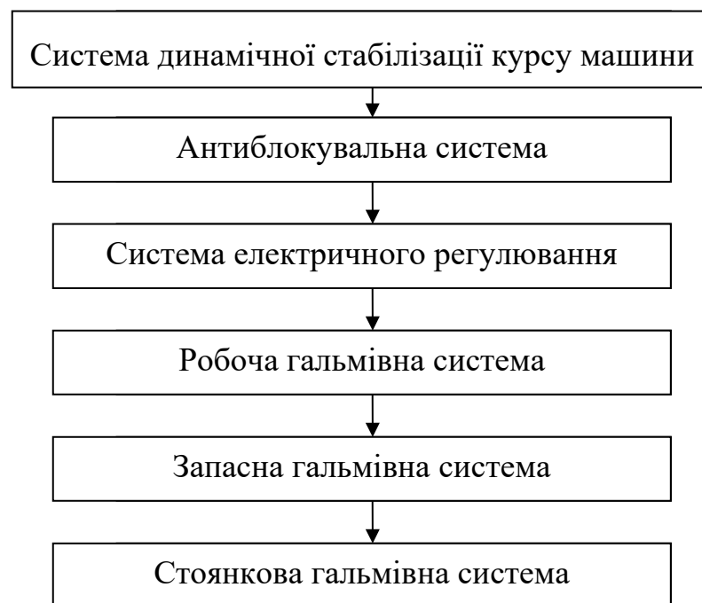
Рисунок 2.3 – Бажана ієрархічна послідовність часткових відмов гальмівного керування
