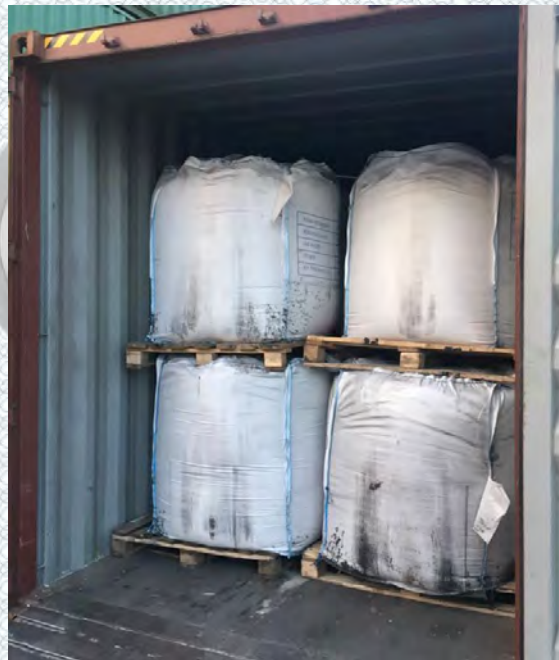
Рисунок 2.4 – Тарний спосіб транспортування зерна а) зовнішній вигляд «біг-бега»; б) спосіб завантаження «біг-бега»; в) приклад розміщення в автомобілі
