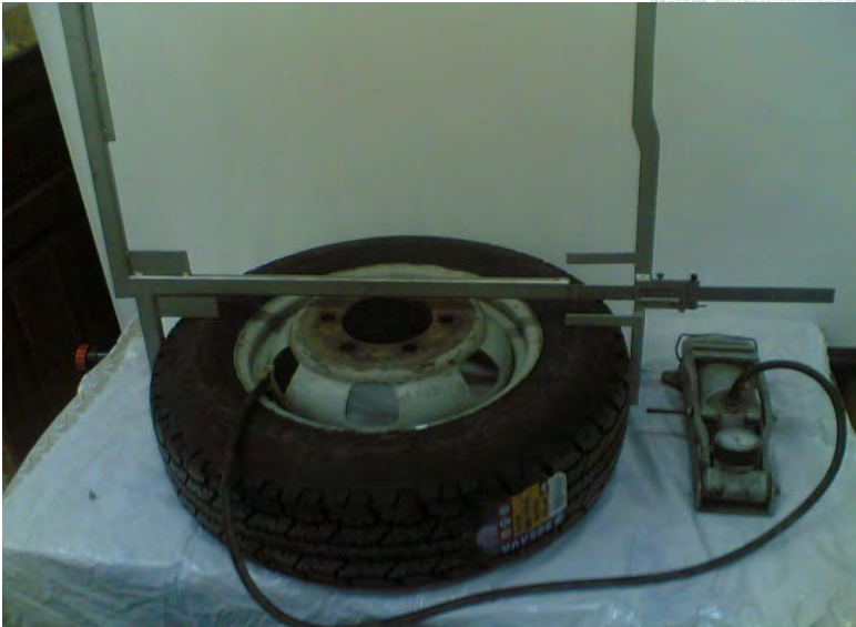
Мірильний інструмент для виміру вільного діаметру шин
