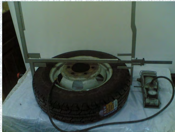
Рисунок 3.12 – Міральный інструмент для виміру вільного діаметру шин
