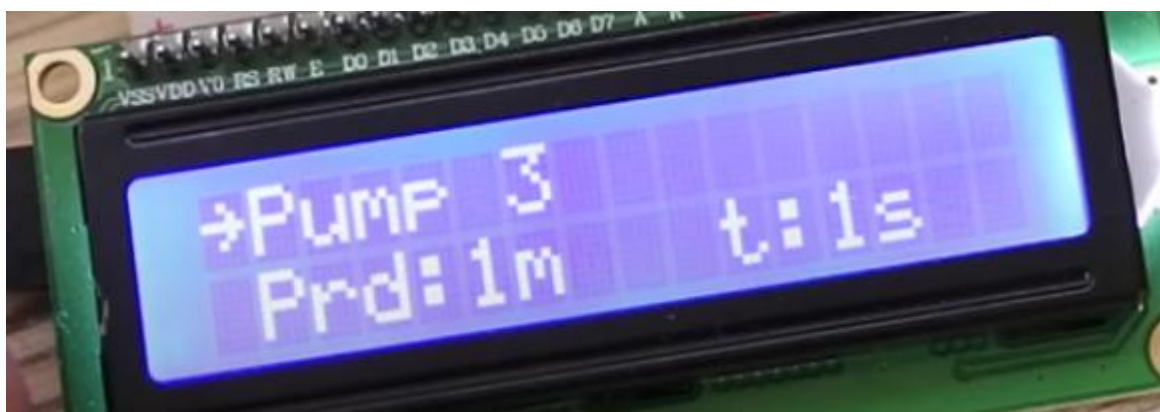
Рисунок 3.5– Налаштування окремих насосів
