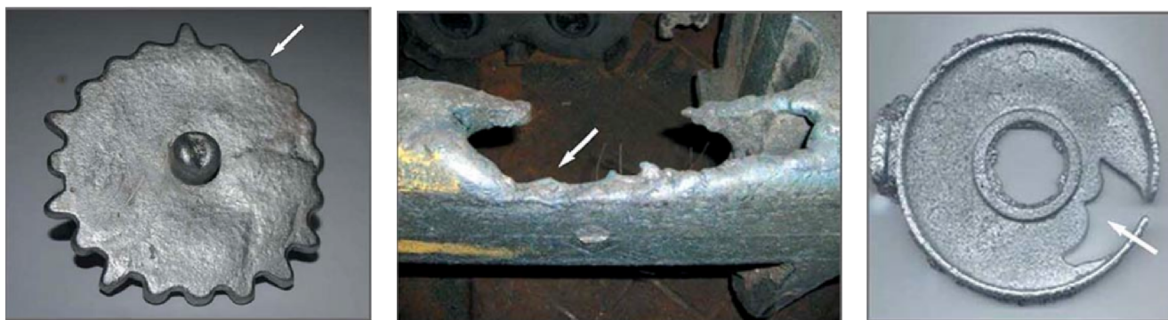
Рисунок 1.1 – Дефекти литої заготовки у вигляді недоливів
