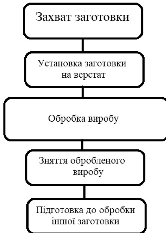
Рисунок 3.1 – Загальний алгоритм роботи автоматизованого робочого місця
