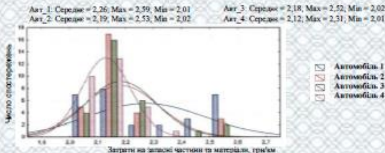
Рисунок 4.21 – Гістограма розподілення і середні значення питомих затрат на запасні частини і матеріали для автомобілів КАМАЗ – 64116 віком до 3-х років
