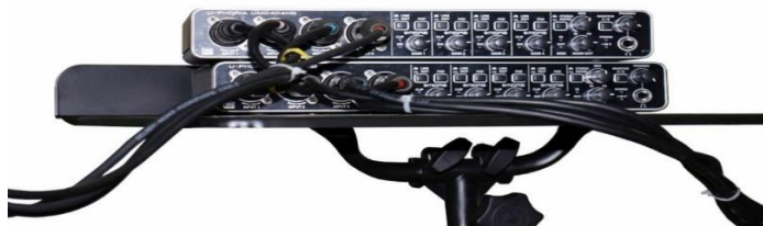
Рисунок 3.7 — 8-канальний варіант входних підсилювачів-перетворювачів на базі аудіоінтерфейсів з Behringer U-Phoria UMC404HD
