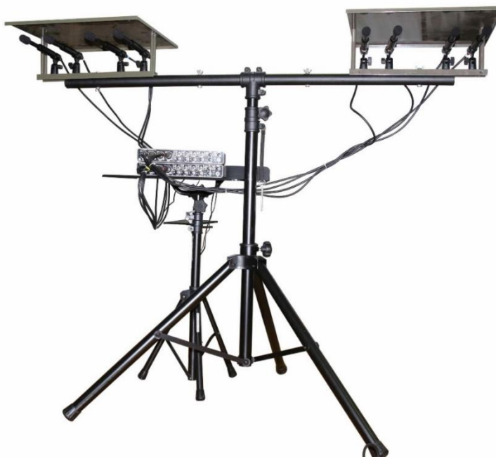
Рисунок 3.8 — Стійки з мікрофонними решітками 8-канальної 2-променевої АЦ-системи сканування акустичних сигналів на місцевості
