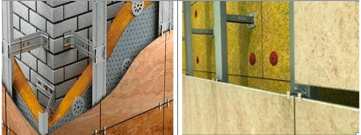
Рис. 4.14. Утеплення стін методом навісного вентилязованого фасаду.
