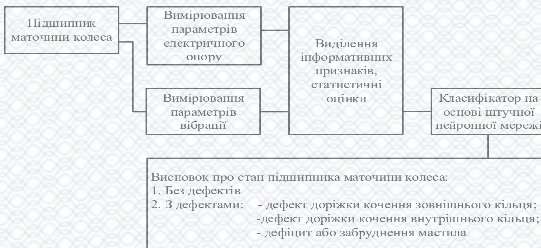
Рисунок 2.6 – Структурна схема методу визначення технічного стану підшипника маточини колеса
