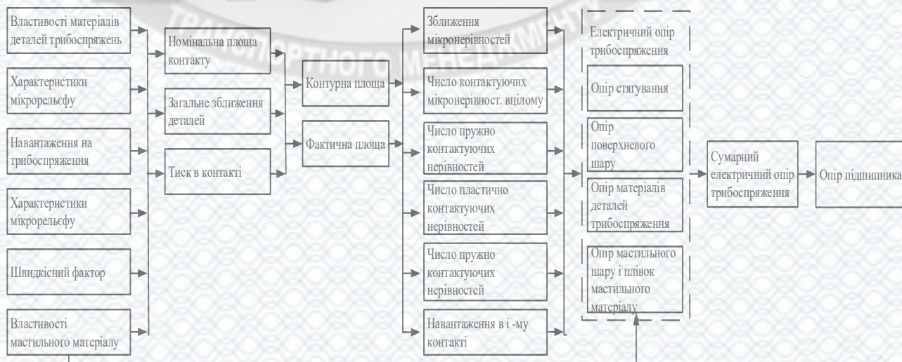
Рисунок 2.4 - Структура математичної моделі опору підшипника
