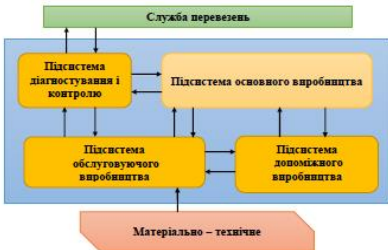
Рисунок 2.2 – Структурна схема функціонування системи технічного обслуговування та поточного ремонту автомобілів на автотранспортних підприємствах
