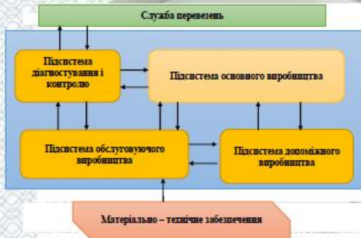
Структурна схема функціонування системи технічного обслуговування та поточного ремонту автомобілів на автотранспортних підприємствах
