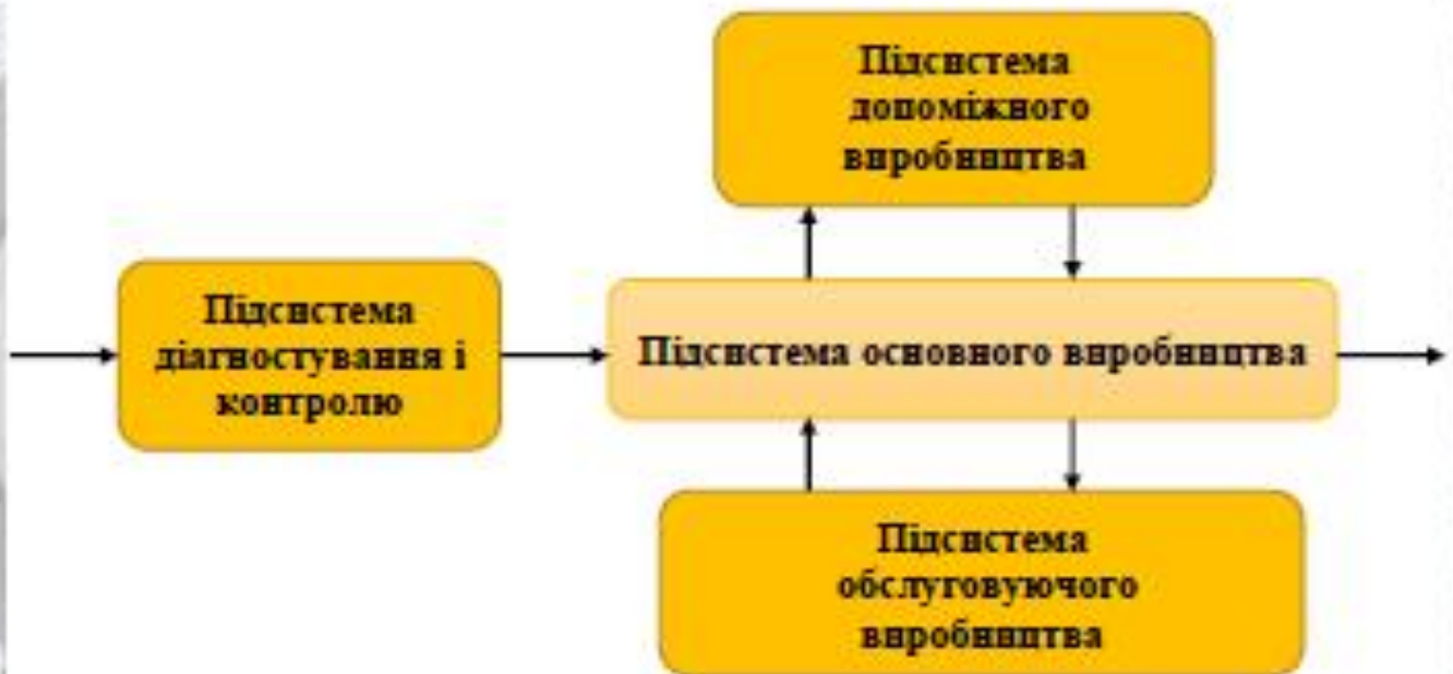
Рисунок 2.3 – Структурна схема системи масового обслуговування (СМО)
