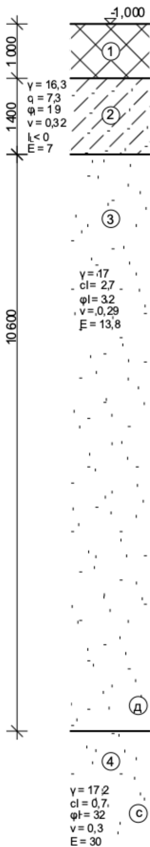
Рис. 4.2 – Інженерно-геологічний розріз будівельного майданчику
