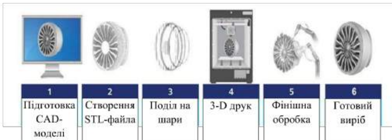
Рисунок 2.1 – Схема реалізації AM-технологій
