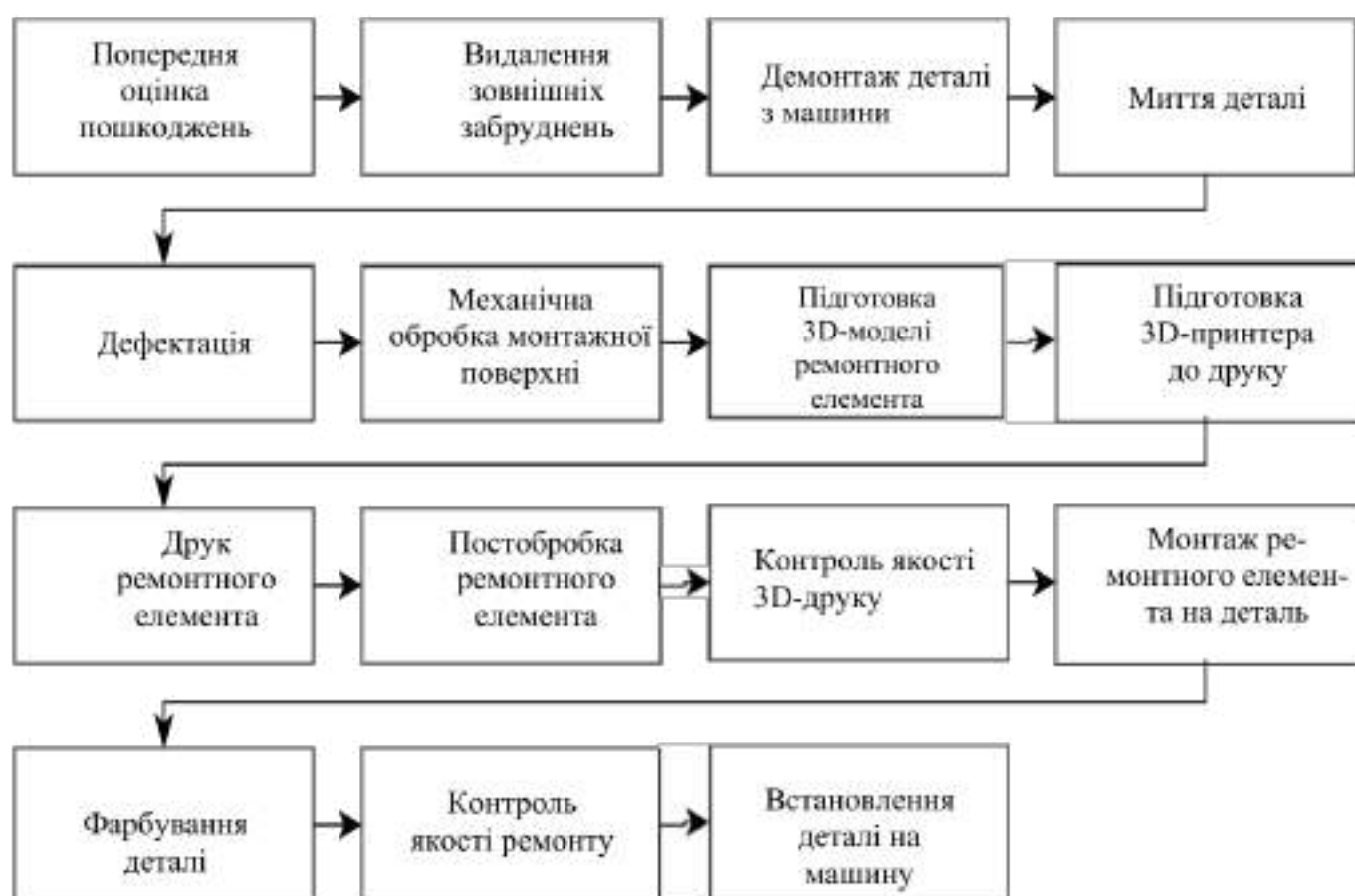
Рисунок 4.6 – Блок-схема технологічного процесу ремонту пластмасових деталей машин із застосуванням адитивних технологій
