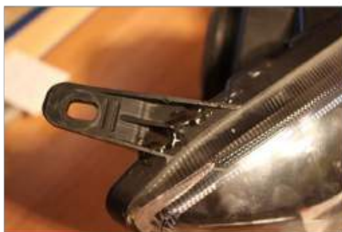
Рисунок 1.13 – Ремонт за допомогою клейової сполуки
