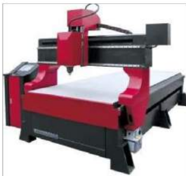
Рисунок 2.19 – Фрезерний розкрійний верстат SG1630. Розкрійний стіл: 1,55×3 м. Листові матеріали, що різуться: деревина, пластик, кольоровий метал
