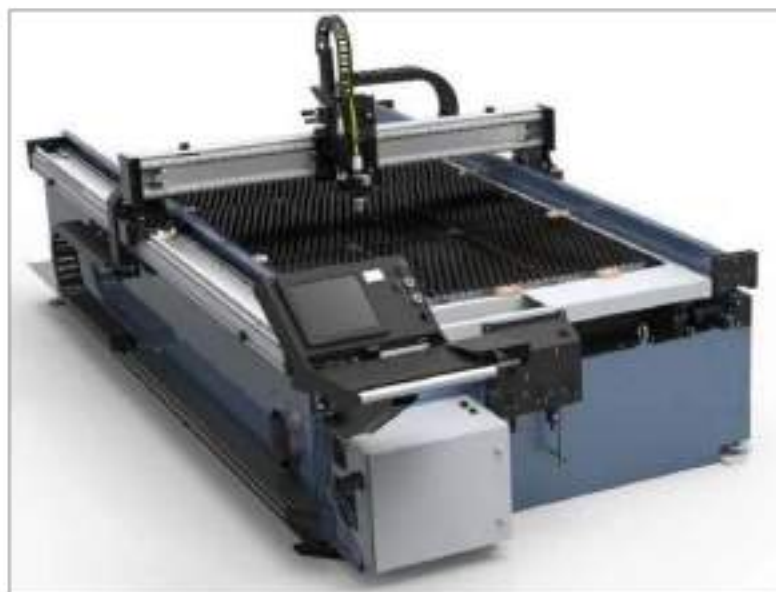
Рисунок 2.18 – Верстат лазерного різання LaserCUT-3015-1. Розкрійний стіл: 1,5×3 м. Листові матеріали, що різуться: сталь, алюмінієві та мідні сплави
