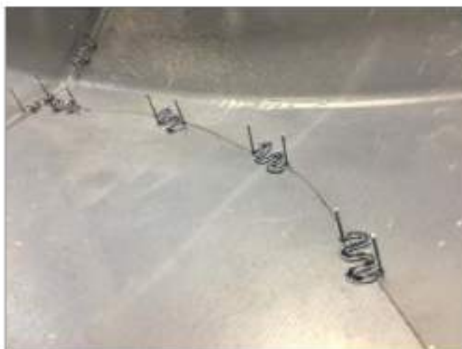
Рисунок А.11 – Відновлення деталі нагрітим елементом
