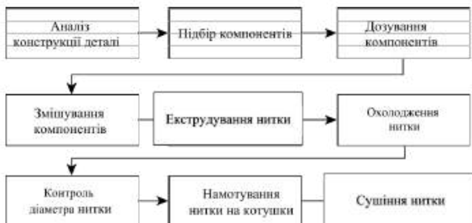
Рисунок 4.3 – Схема операцій технологічного процесу виготовлення філаменту для 3D-друку
