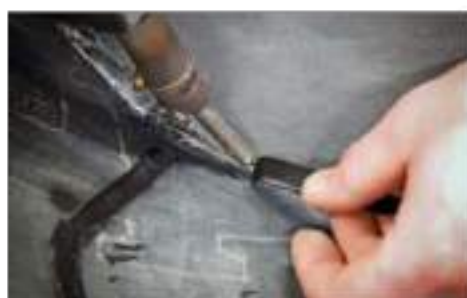
Рисунок 1.7 – Відновлення деталі зварюванням нагрітим газом
