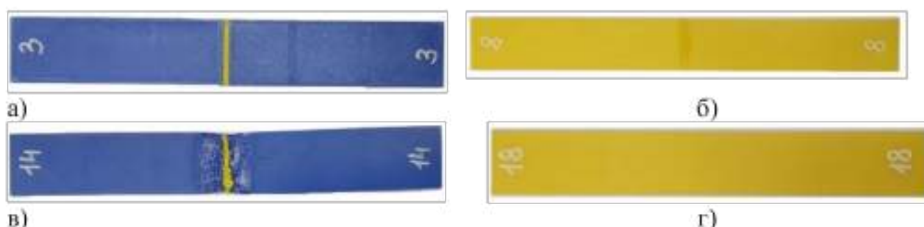
Рисунок А.19 – Зразки, з'єднані 3D-зварюванням (а), склеєні (б), зварені нагрітим повітрям (в), цілісні (г)
