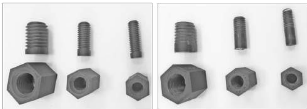
Рисунок Б.3 – Загальний вигляд різьбових поверхонь, одержаних: 3D-друком (а); нарізанням ручним різьбовим інструментом (б)
