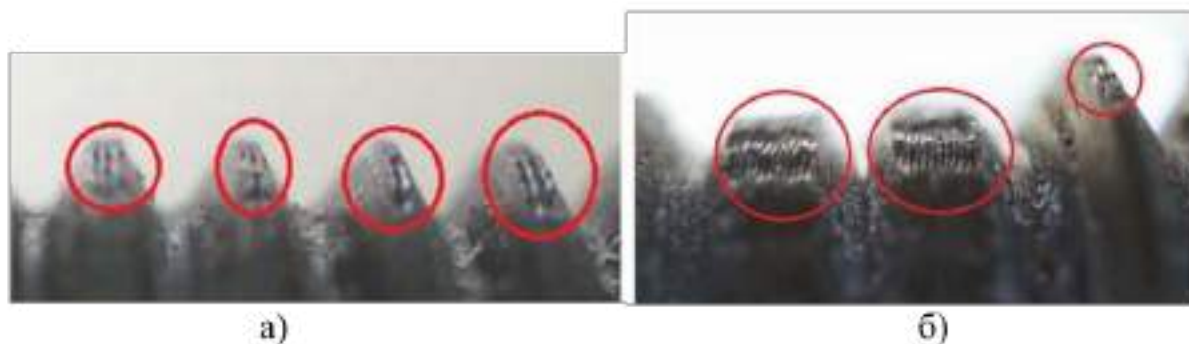
Рисунок Б.6 – Термічна усадка матеріалу деталі (а); крихтування поверхневого шару деталі (б)
