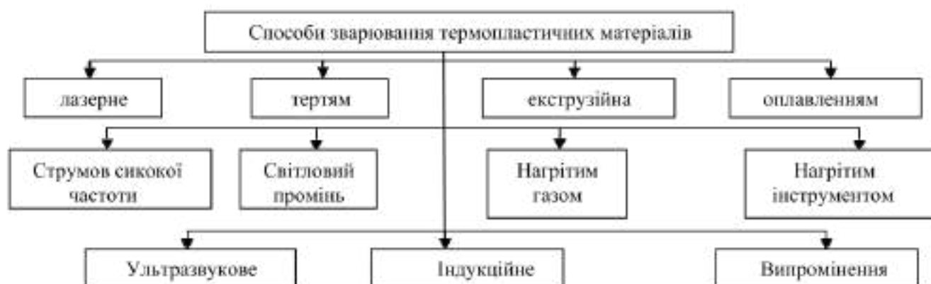
Рисунок 1.6 – Класифікація способів зварювання термопластичних матеріалів
